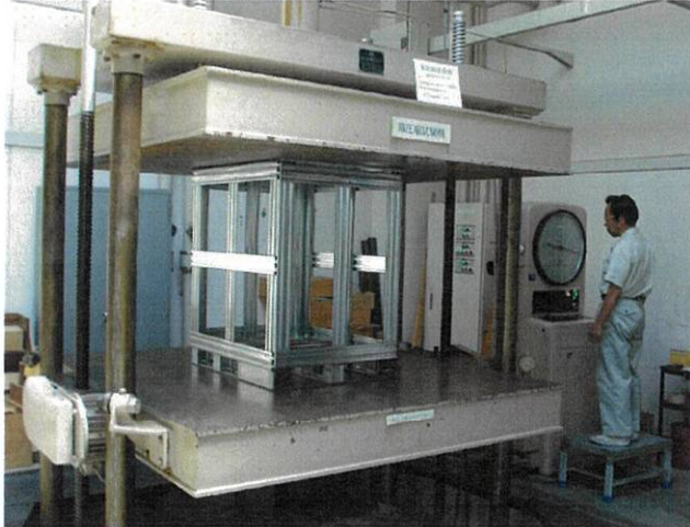
あいち産業科学技術総合センターに於ける箱圧縮試験 箱圧縮強度 45.4KN (4,630KG)まで耐荷重保持
